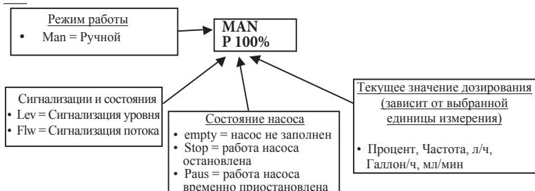
Параграф 2 – Пропорциональное дозирование для сигнала 0/4-20 мА
