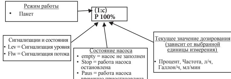
Параграф 7 – Пропорционально внешним импульсам (дозирование в мг/кг)
